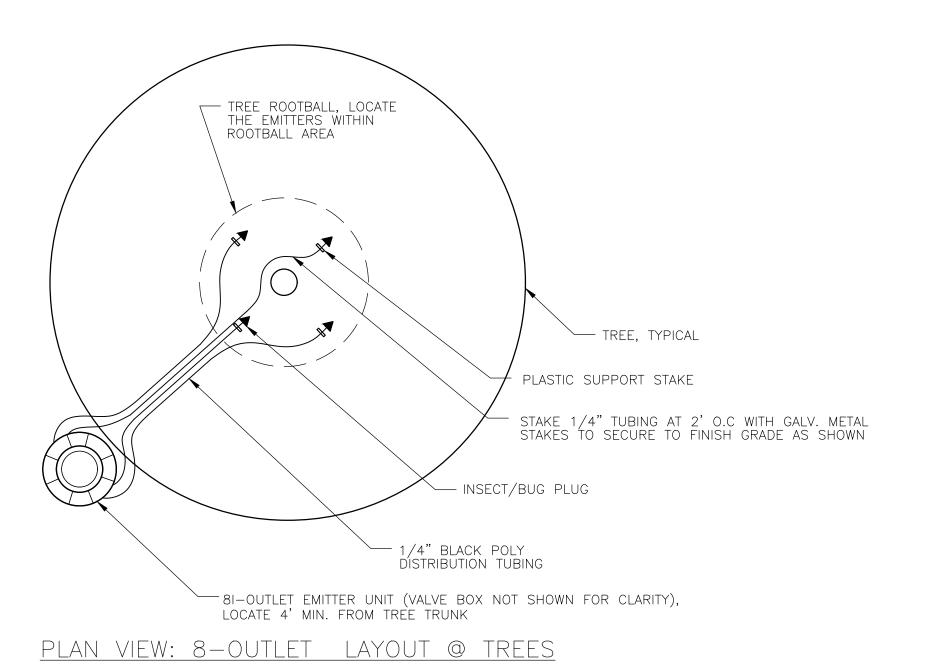
8-OUTLET DRIP EMITTER ON RISER DETAIL
