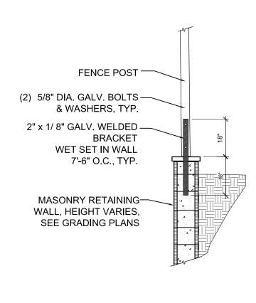
FENCE POST CONNECTION ON RETAINING WALL
