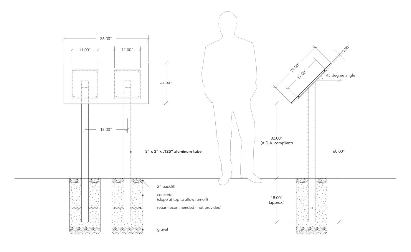
**ELEVATION VIEW** SIDE VIEW scale: 1" = 1' scale: 1" = 1'
