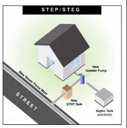
FIGURE 3-1 PESCADERO COMMUNITY SEWER PROJECT SMALL COMMUNITY WASTEWATER GRANT FACILITIES PLAN GRAVITY COLLECTION VS. STEP/STEG
