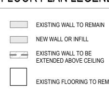
NEW WALL OR INFILL EXISTING WALL TO BE EXTENDED ABOVE CEILING
