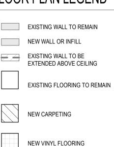
EXISTING WALL TO REMAIN NEW WALL OR INFILL EXISTING WALL TO BE EXTENDED ABOVE CEILING
